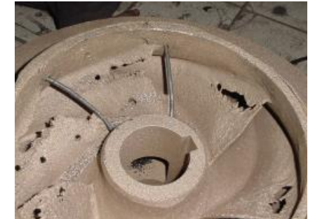
Rotores danificados pela cavitação
