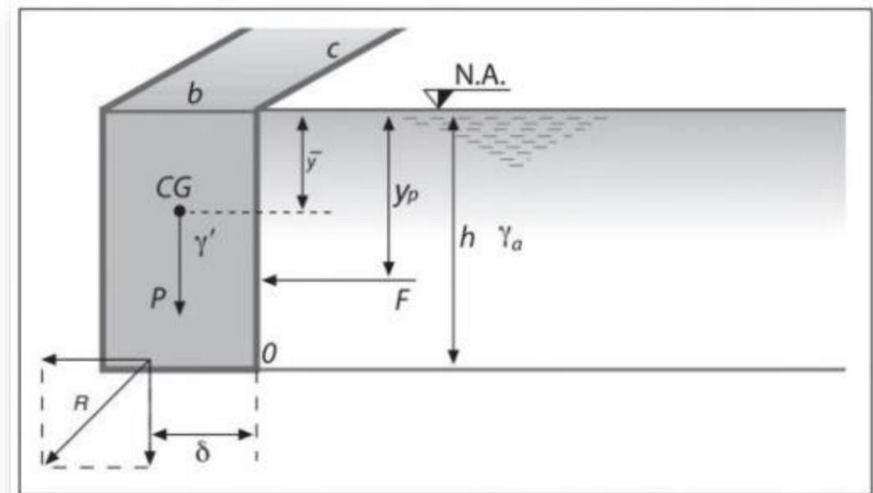
Figura A-2.7-a – Esforços em um muro de retenção.
