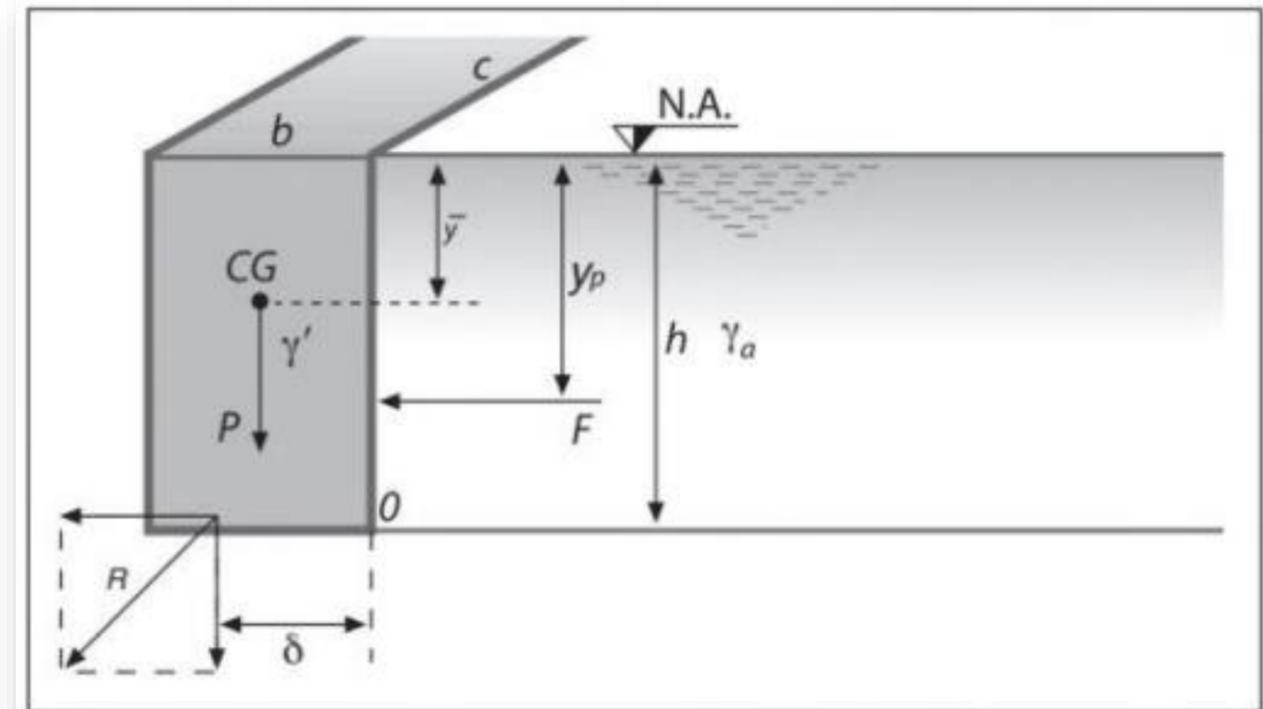
Figura A-2.7-a – Esforços em um muro de retenção.
