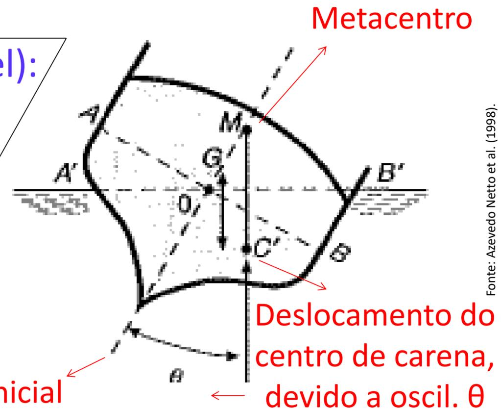
**Exercício 3.1** — Seja um prisma retangular de madeira com as dimensões indicadas na (Fig. 3.2) e de densidade 0,82. Pergunta-se se o prisma flutuará ou não, em condições estáveis, na posição mostrada na figura.
